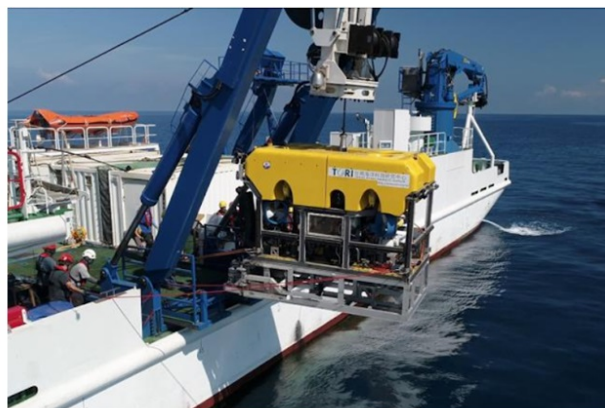
水下遙控無人載具 (ROV) 是在深海高壓環境下工作的機器人，透過遠端遙控執行採樣、測量與記錄任務。(圖片來源：台灣海洋科技研究中心)
